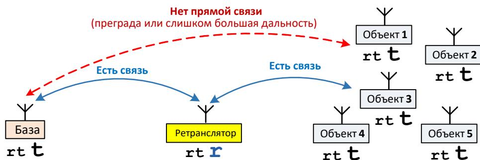
Модему, который будет ретранслятором, в этом случае нужно задать работу в качестве ретранслятора (**rt r**), а для всех остальных модемов системы (и "базе" и "объектам") задать работу через ретранслятор (**rt t**).
