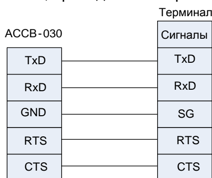
Рис.10. Схема подключения АССВ-030 к терминалу аппаратного управления потоком.
