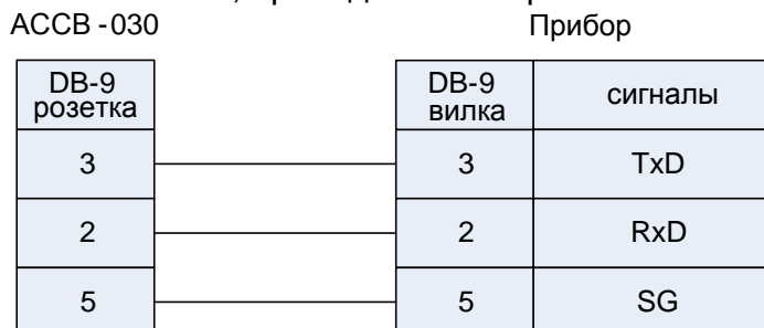
Рис.3. Подключение прибора по интерфейсу RS-232.
