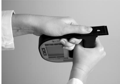
Abb. 11 - 3 Pumpenverriegelung entfernen
