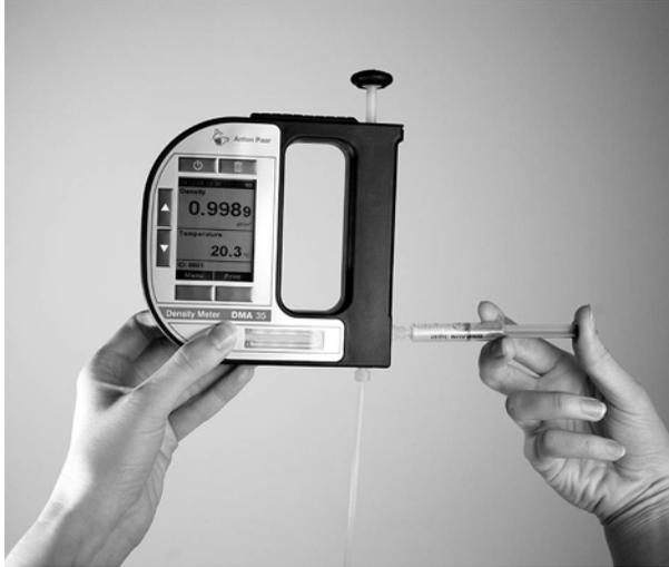
Abb. 9 - 2 Probe mithilfe einer Spritze einfüllen
