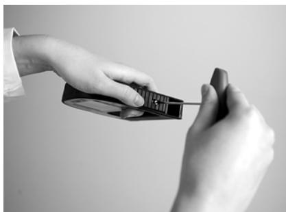
Abb. 11 - 2 Schraube für die Pumpenverriegelung entfernen
