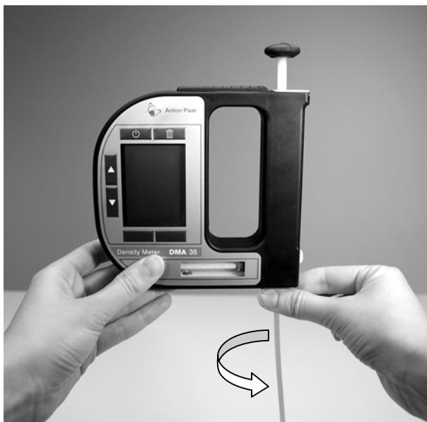
Abb. 7 - 1 Saugrohr anschließen
