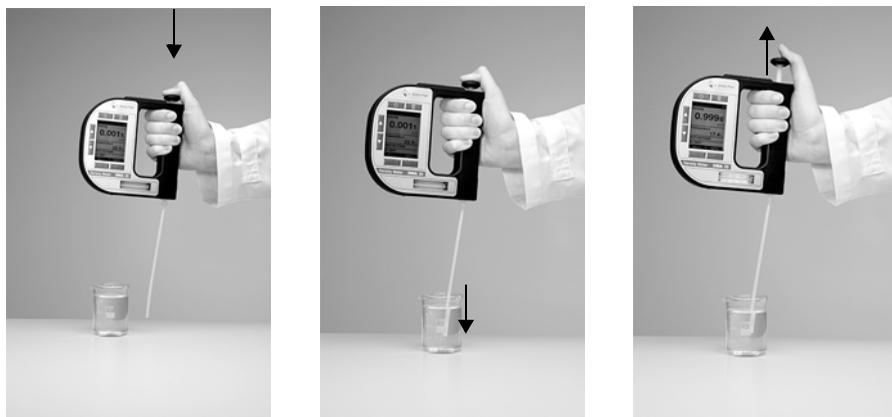
Abb. 9 - 1 Probe über das Saugrohr einfüllen
