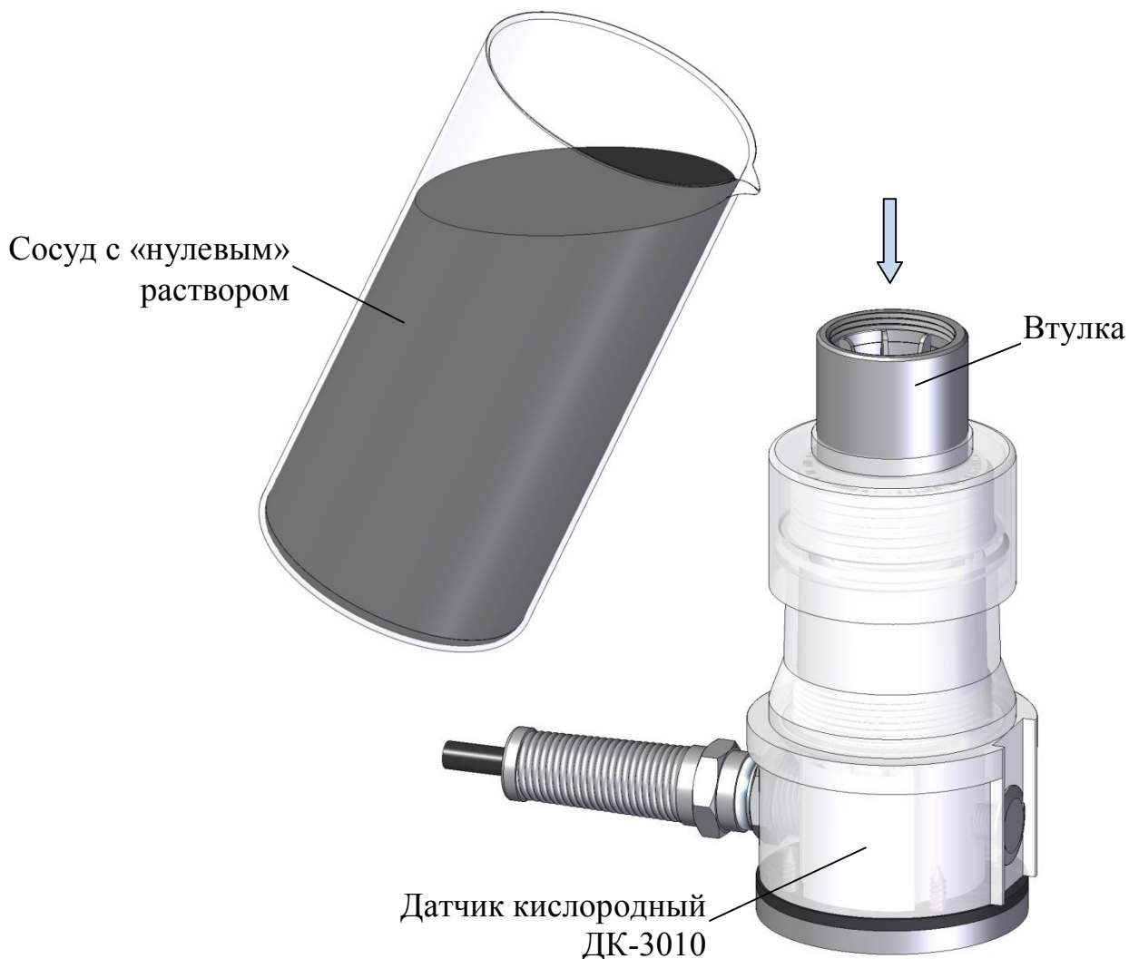
Рисунок 2.2 – Проверка показаний в «нулевом» растворе
