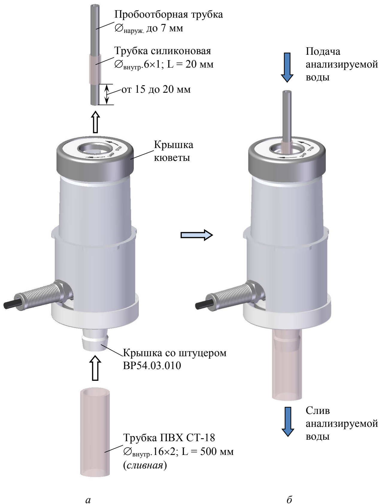
Рисунок 2.8 – Крепление кюветы на пробоотборной трубке с наружным диаметром до 7 мм
