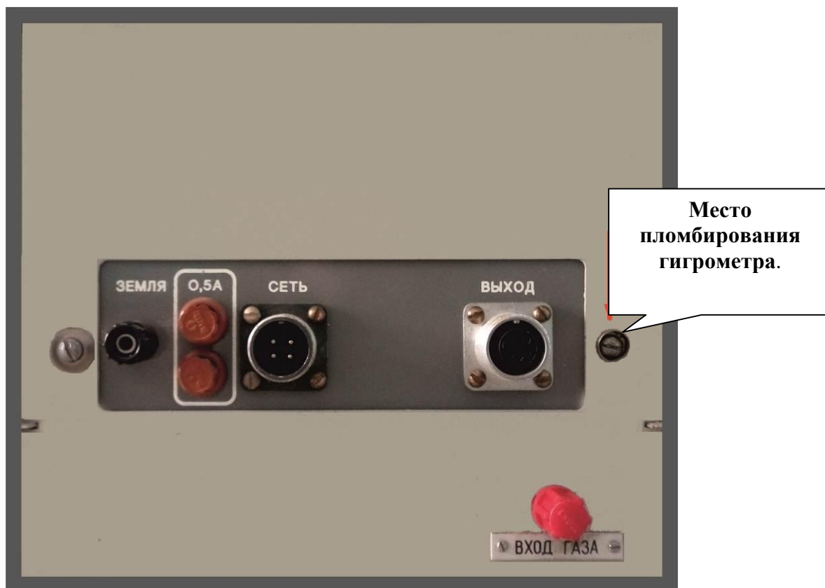
Рисунок 2 - Задняя панель гигрометра БАЙКАЛ-5Ц
