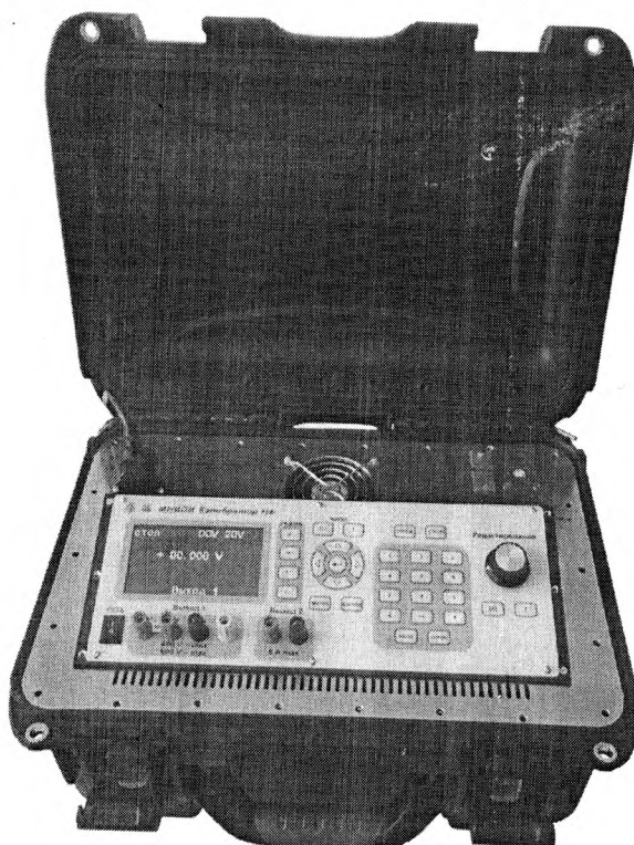
Рисунок 1 – Внешний вид калибратора Н4-301.
