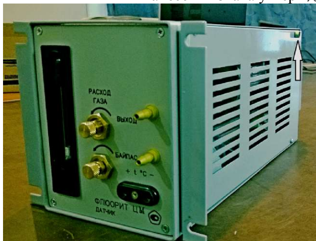
Рисунок 1 - Блок измерения ИСП1. Схема пломбировки от несанкционированного доступа. Места для пломбирования обозначены стрелками. Прямоугольником обозначено место нанесения знака утверждения типа и знака поверки.
