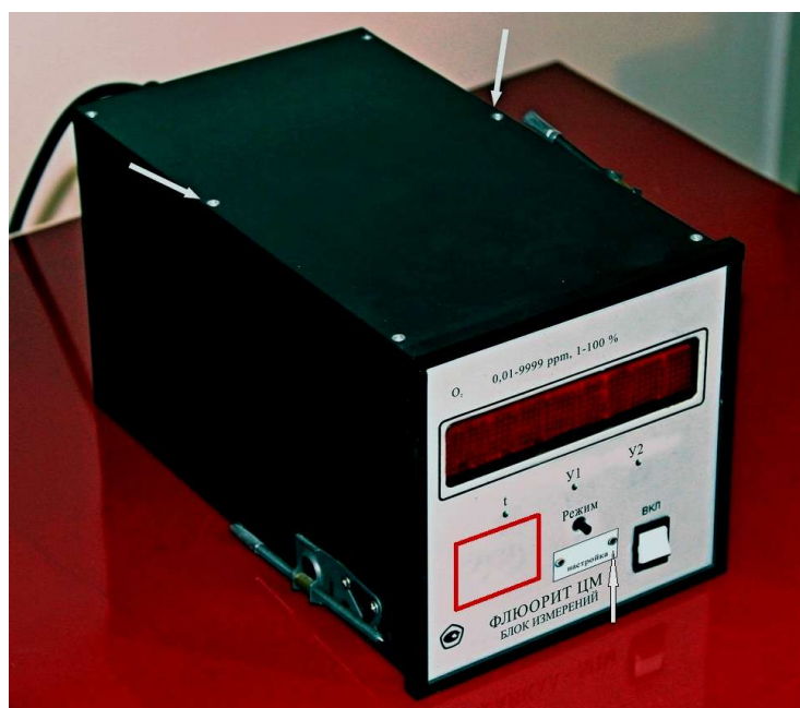
Рисунок 3 - Блок измерения ИСП2. Схема пломбировки от несанкционированного доступа. Места для пломбирования обозначены стрелками. Прямоугольником обозначено место нанесения знака утверждения типа и знака поверки.
