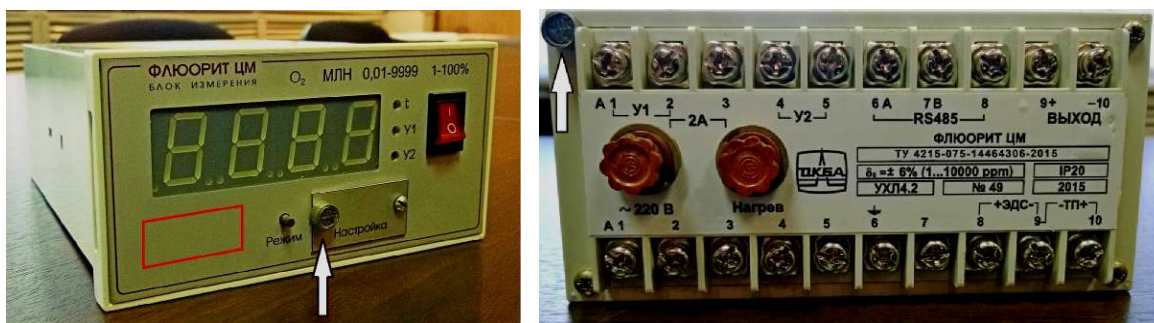
Рисунок 1 - Блок измерения ИСП1. Схема пломбировки от несанкционированного доступа. Места для пломбирования обозначены стрелками. Прямоугольником обозначено место нанесения знака утверждения типа и знака поверки.
