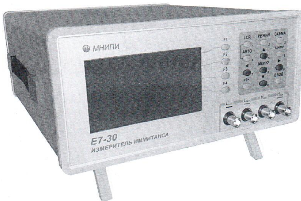
Рисунок 1 – Измеритель иммитанса E7-30. Внешний вид.
