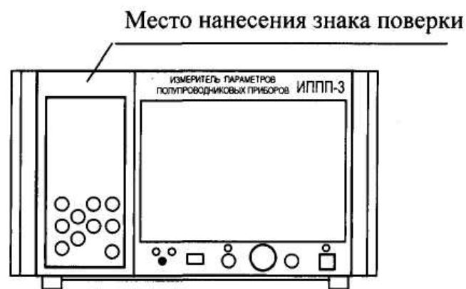
Рисунок А.2 – Место нанесения знака поверки (лицевая панель прибора)
