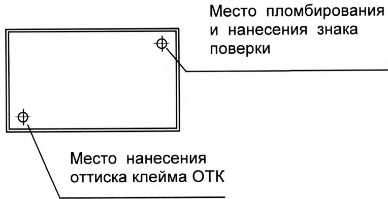
Рисунок А.1 – Места пломбирования и нанесения знака поверки
