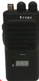
2.6. При использовании радиостанции в стационарных условиях или в салоне автомобиля для увеличения дальности радиосвязи необходимо подключение внешней стационарной, балконной или автомобильной антенны (**диапазон 27МГц**). При работе из зданий/автомобиля со штатной антенной дальность связи будет мала ввиду экранирующего воздействия стен/корпуса автомобиля.
