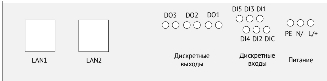
Рисунок 1.14. Расположение клемм и интерфейсов ЭНИП-2-0-...-X3
