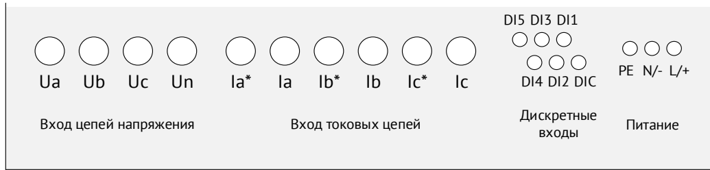
Рисунок 1.13. Расположение клемм ЭНИП-2-...-X3
