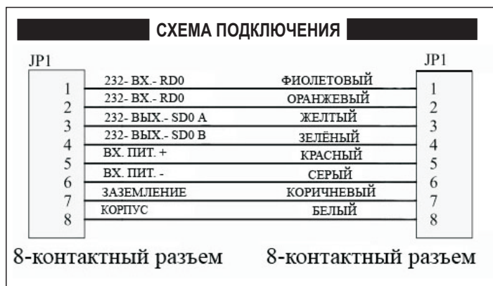
Схема подключения при помощи 8-контактного разъема DSUB
