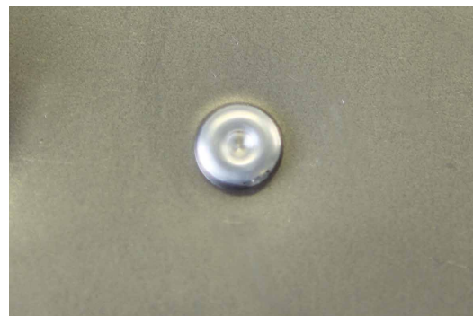
RISULTATO DELLA POSA DI UN RIVETTO FLOW-FORM
