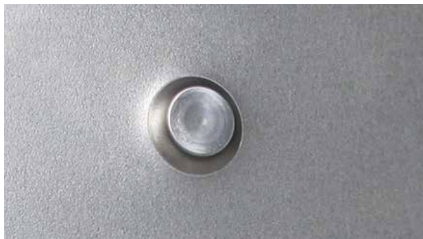
RISULTATO DELLA POSA DI UN RIVETTO AUTO-PERFORANTE
