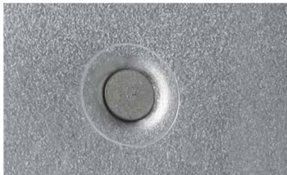
AFBEELDING PONSNAGEL VERBINDING VOOR- EN ACHTER-ZIJDE
