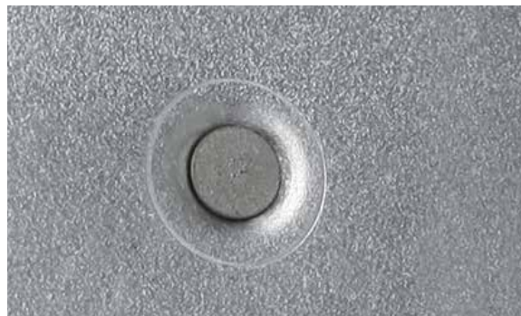
RÉSULTAT DE POSE D'UN RIVET AUTO-PERÇANT
