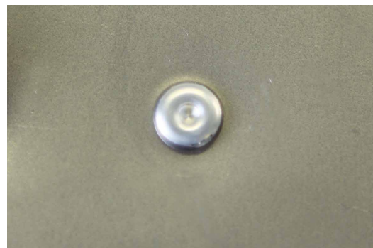
RÉSULTAT DE POSE D'UN RIVET FLOW-FORM
