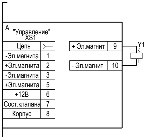
Рис. 2 – КЗЭУГ. Схема электрическая принципиальная
