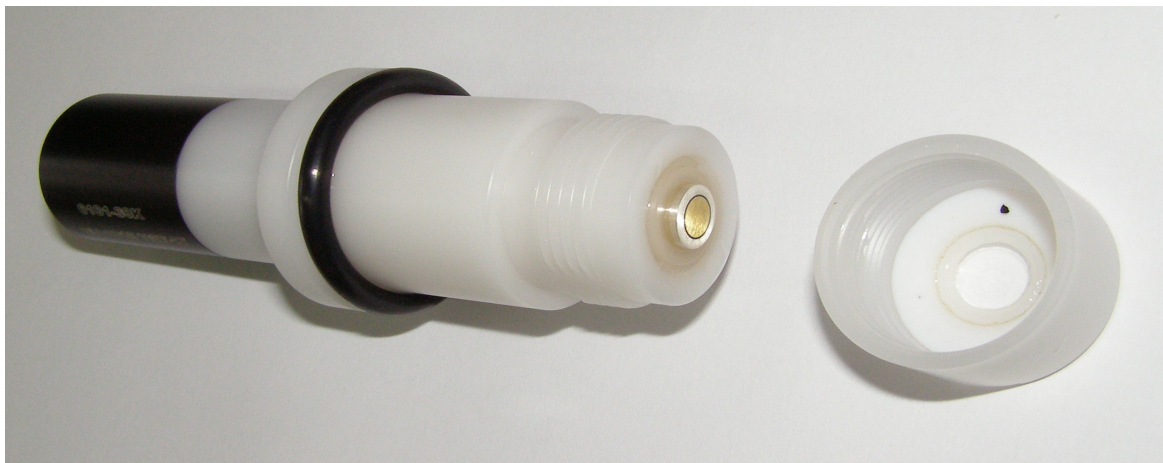
Рисунок 3 - Датчик кислорода со снятым мембранным картриджем
