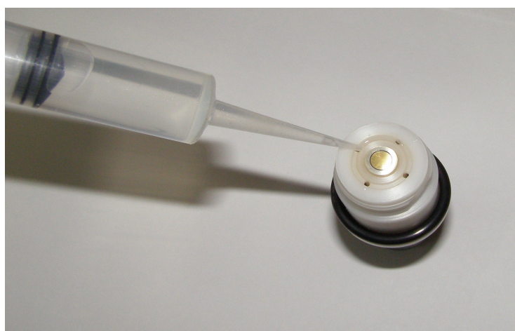
Рисунок 5 - Заливка электролита в датчик
