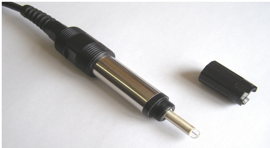
Рисунок 6 - Датчик кислорода со снятым мембранным картриджем
