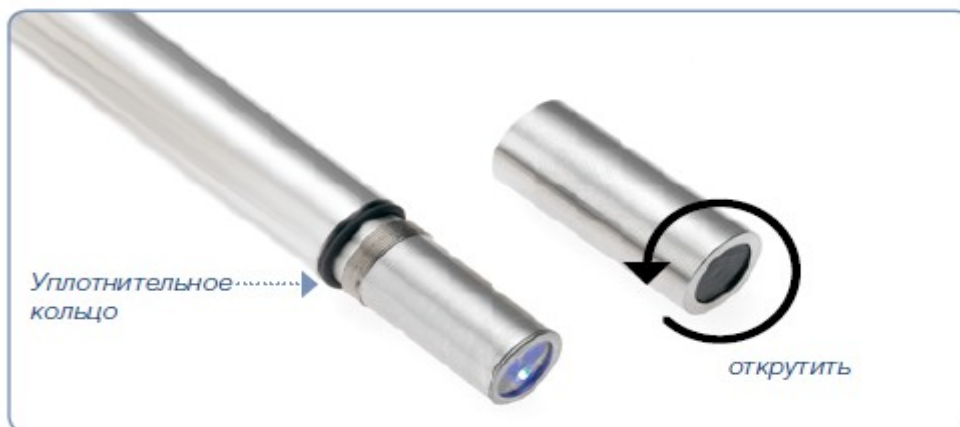
Рисунок 7 - Замена колпачка оптического (ECS) датчика
