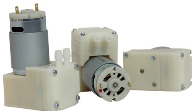
Рисунок D.17 - Компрессор для очистки погружных датчиков (12 VDC, 0.6 A, давление до 1,5 бар, расход воздуха до 4 л/мин, габариты 74×51×32 мм)
