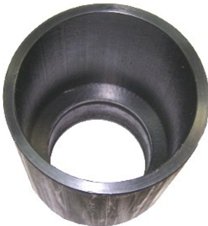
Рисунок D.13 - Ячейка калибровочная для поверки и регулировки погружных датчиков
