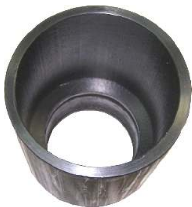
Рисунок А.8 — Калибровочная ячейка для проверки и регулировки погружаемых датчиков
