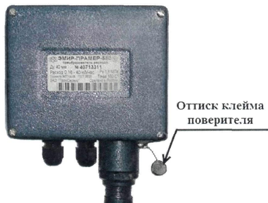
Рисунок 3 – Место пломбирования ЭП в стальном корпусе
