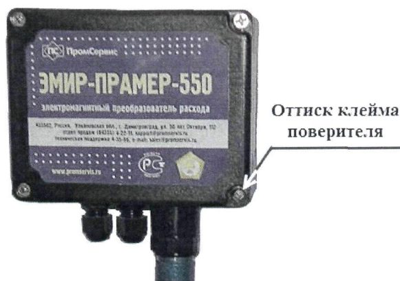
Рисунок 4 – Место пломбирования ЭП в пластиковом корпусе
