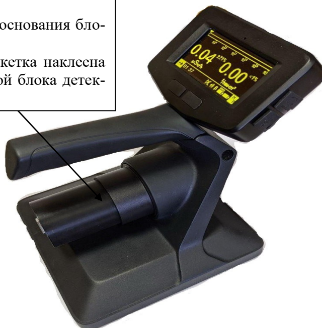
Рисунок 3 – Общий вид дозиметра-радиометра с держателем, блоком детектирования БДЗА-Р5Д и схема пломбировки от несанкционированного доступа
