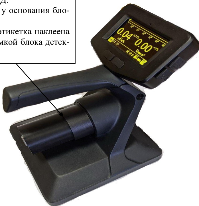
Рисунок 2 – Общий вид дозиметра-радиометра с держателем, блоком детектирования БДЗБ-Р5Д и схема пломбировки от несанкционированного доступа
