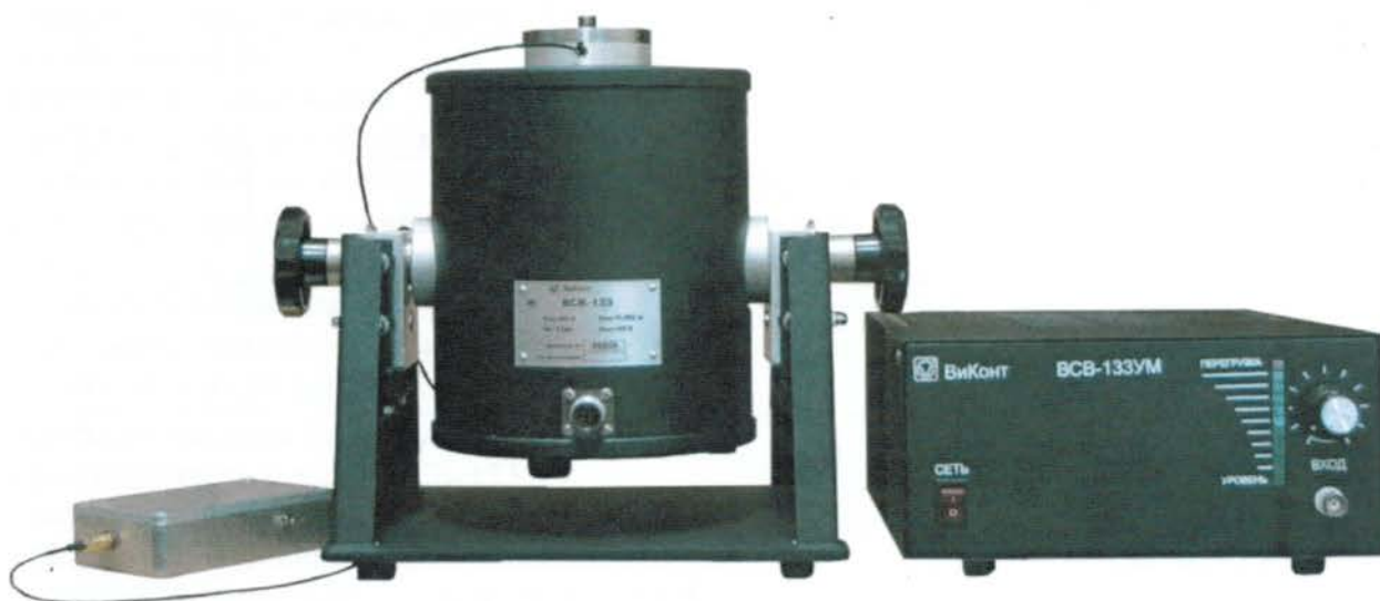
Рисунок 1 – Общий внешний вид виброустановки электродинамической ВСВ-133
