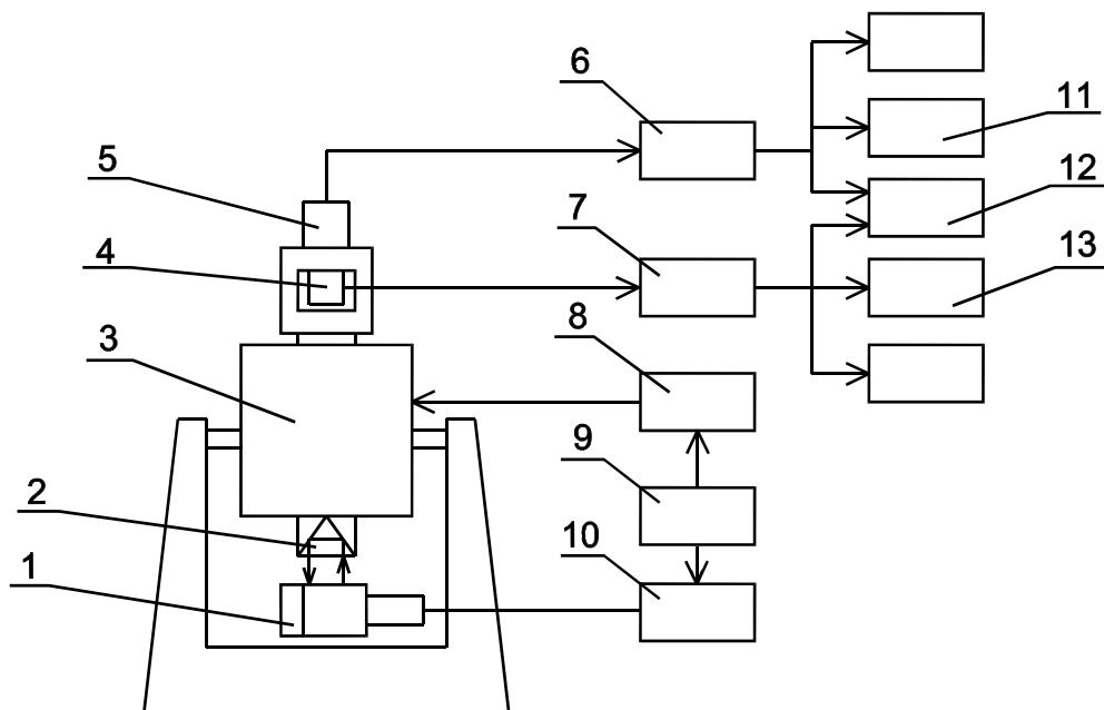
1, 2, 10 – Лазерный измеритель вибрации:
