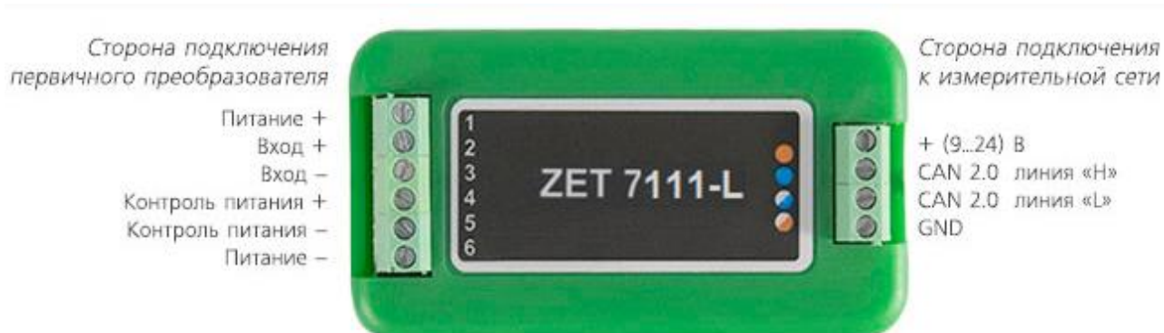
Рис. 2.3 Обозначении контактов ZET 7111-L в лабораторном исполнении
