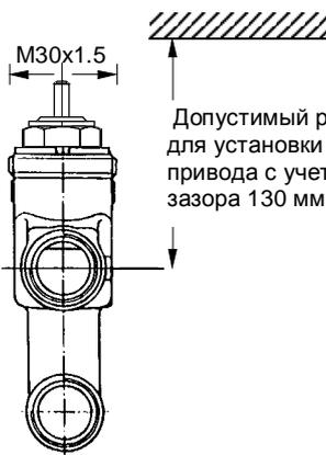
Допустимый размер для установки привода с учетом зазора 130 мм
