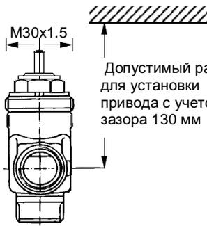
Допустимый размер для установки привода с учетом зазора 130 мм
