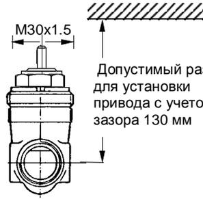
Допустимый размер для установки привода с учетом зазора 130 мм
