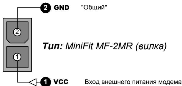
Рисунок 4.1 - Разъем «POWER». Вид на разъем со стороны коммутации
