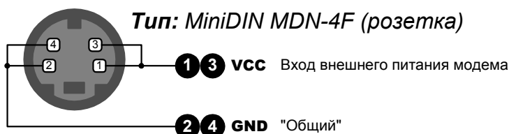
Рисунок 4.2 - Разъем «POWER» в «старом» исполнении модема (до 2004 года). Вид на разъем со стороны коммутации
