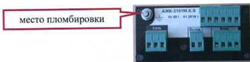
Рисунок 9 - Схема пломбирования АЖК 3101, АЖК-3101М, АЖК-3101ВП, АЖК-3102
