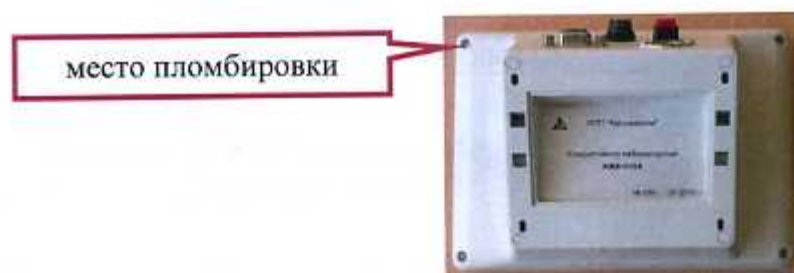
Рисунок 10 - Схема пломбирования АЖК-3104
