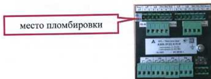
Рисунок 12 - Схема пломбирования АЖК-3122, АЖК-3122.П (щитовой вариант)
