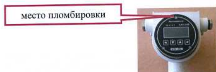
Рисунок 13 - Схема пломбирования АЖК-3110, АЖК-3130
