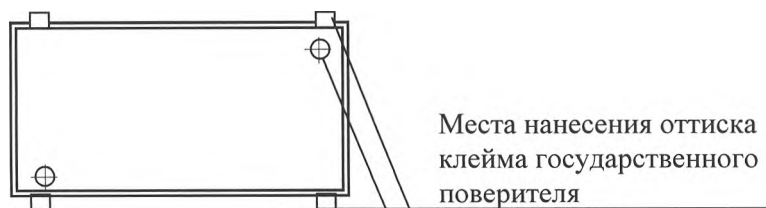
Рисунок 1 - Места нанесения отиска клейма государственного поверителя (задняя панель прибора).
