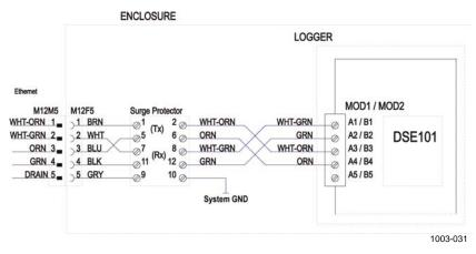
Figure 133 DSE101 Ethernet Module Wiring Diagram
