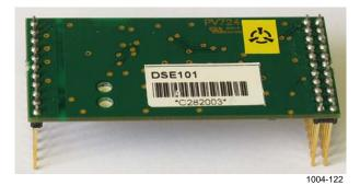
Figure 132 Ethernet Communication Module DSE101
