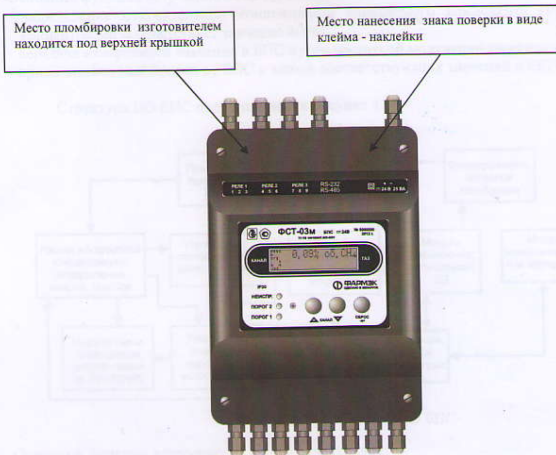
Рисунок 2 - Схема пломбировки для защиты от несанкционированного доступа и обозначение мест для нанесения оттисков клейм
