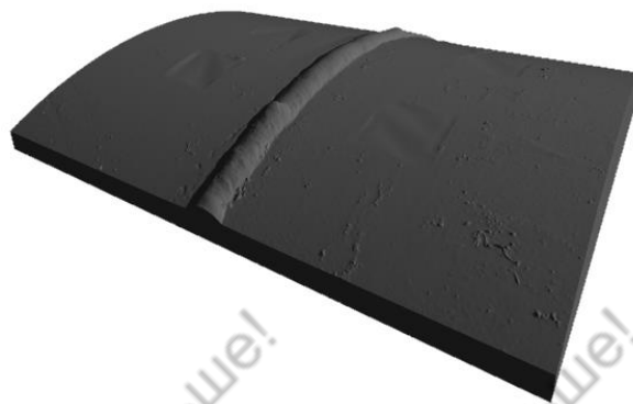
Рисунок 32. ПРИМЕР СВАРНОГО СТЫКОВОГО СОЕДИНЕНИЯ ТИПА «ТРУБА+ТРУБА»
