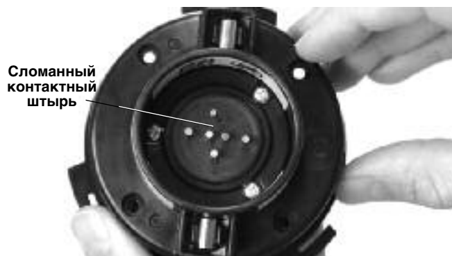
Рис. 7. Сломанный контактный штырь
