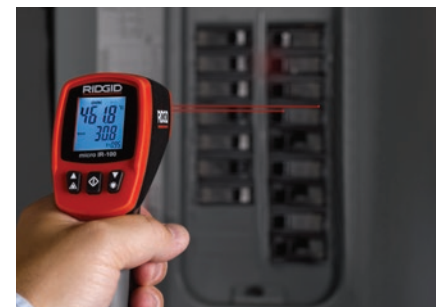
Проверка предохранителя или автоматического прерывателя на предмет перегрева, который могут вызвать перегруженные электрические цепи
