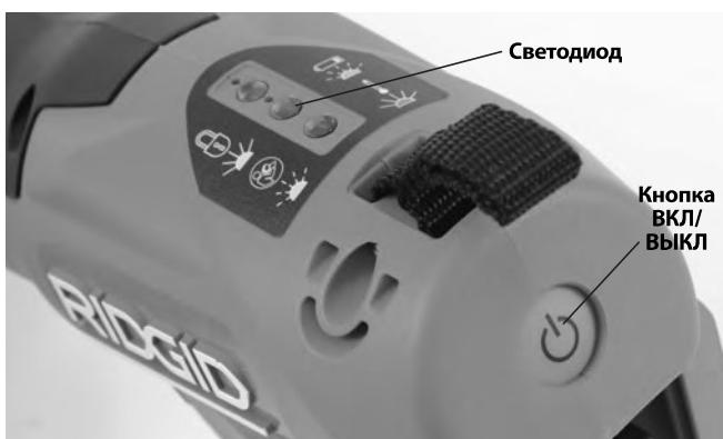
**Рис. 3 – Индикаторы состояния инструмента**
