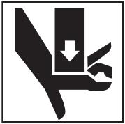
**Во время рабочего цикла оберегайте пальцы и руки от насадки. Ваши пальцы или руки могут быть раздавлены, раздроблены или ампутированы при попадании в насадку или в инструмент, или между насадкой, заготовкой и другими деталями.**
