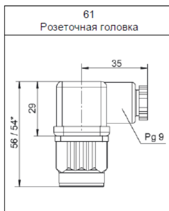
Рисунок 2 - Размеры частей электрического подключения датчика давления
