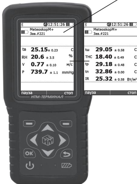
При измерениях в центральной части экрана блока НТМ-Терминал отображаются результаты измерений параметров микроклимата и значение расширенной неопределенности (по ГОСТ 34100.3-2017).
