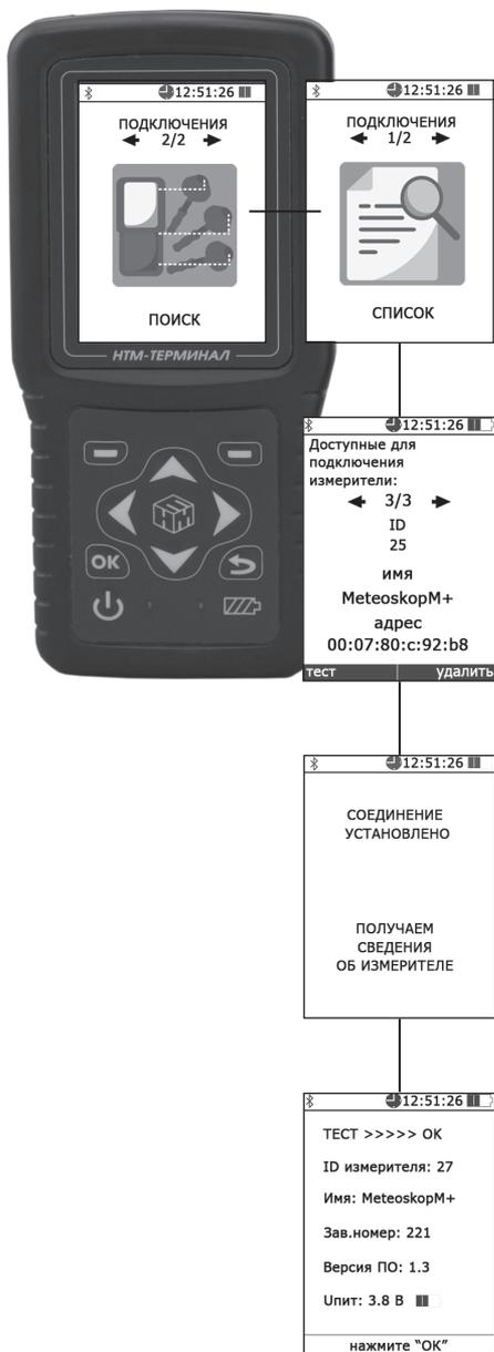
4. С помощью кнопок **◀** и **▶** перейти к пункту меню «ПОДКЛЮЧЕНИЯ» и нажать кнопку **OK**. При этом осуществится переход в меню «ПОДКЛЮЧЕНИЯ» к пункту «СПИСОК».
