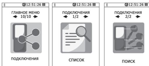
При просмотре списка подключений на экране блока НТМ-Терминал отображается название измерительного блока или датчика, заводской номер и его bluetooth адрес. Для перехода от одного пункта списка к другому используются кнопки **◀** или **▶**.
