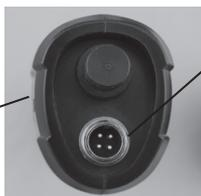
Если при измерениях будет использоваться шаровой термометр, то необходимо установить его в соответствующий разъем на измерительном блоке.
