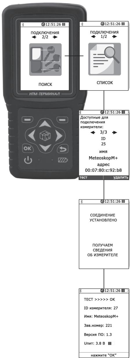
**4.** С помощью кнопок **◀** и **▶** перейти к пункту меню «ПОДКЛЮЧЕНИЯ» и нажать кнопку **OK**. При этом осуществляется переход в меню «ПОДКЛЮЧЕНИЯ» к пункту «СПИСОК».
