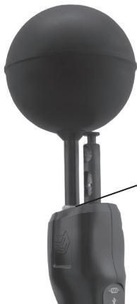
1. Перед началом работы необходимо выдвинуть сенсометрический щуп из измерительного блока.
