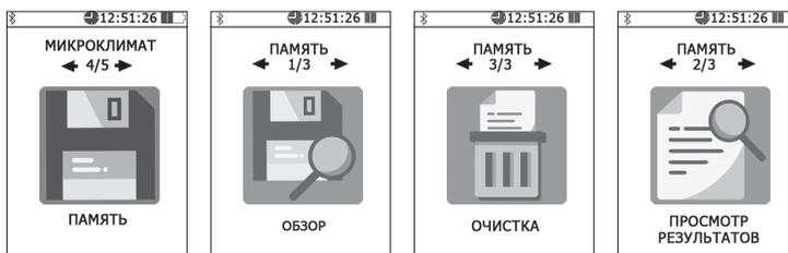
следованных контролируемых зонах, суммарном количестве сделанных замеров и объеме свободного места. При активизации пункта **«просмотр»** в меню **«память»**, на экране блока НТМ-Терминал отображается список контролируемых зон, где проводились измерения. Нужная контролируемая зона выбирается по номеру и дате проведения измерений с помощью кнопок **◀** и **▶**.
