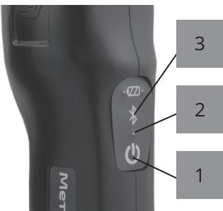
После включения питания измерительный блок находится в режиме ожидания соединения с управляемым устройством (блок HTM-Терминал или ПК с предустановленным программным обеспечением), об этом свидетельствует мигающий индикатор 3.
