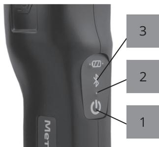
После включения питания измерительный блок находится в режиме ожидания соединения с управляющим устройством (блок НТМ-Терминал или ПК с предустановленным программным обеспечением), об этом свидетельствует мигающий индикатор 3.
