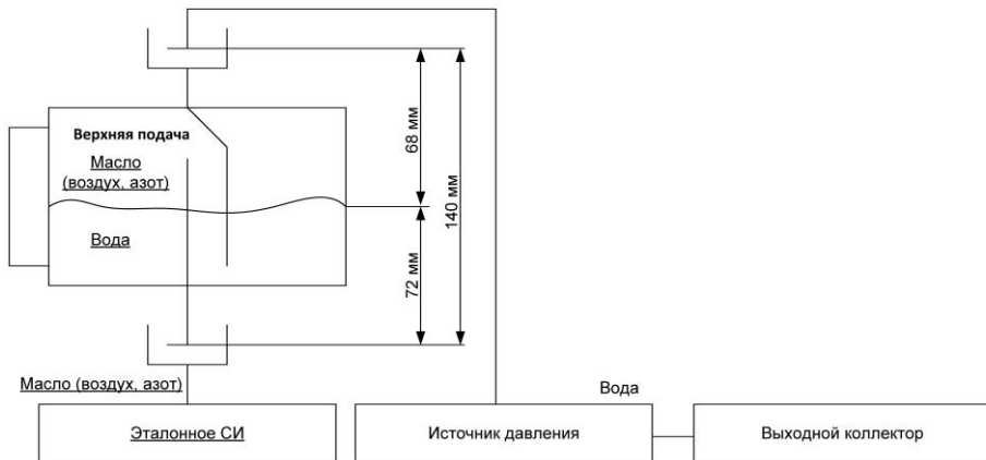
Рисунок 3 Схема РСВ-250 с верхней подачей рабочей жидкости
