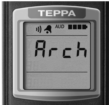
Рисунок 2.14 – Сохранение результата измерения в энергонезависимой памяти
