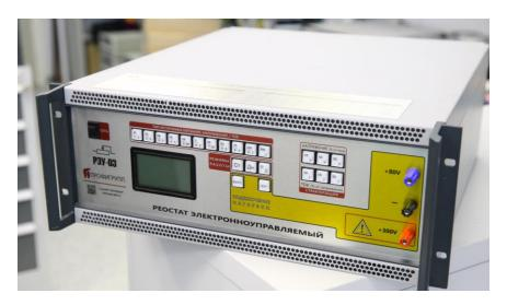
Конструктивно корпус РЭУ выбран в исполнении, максимально исключающем прохождения внешних наводок внутрь корпуса. Разделение узлов и расположение их внутри корпуса минимизирует возможное взаимное влияние и распространение внутри корпуса возможных наводок.
