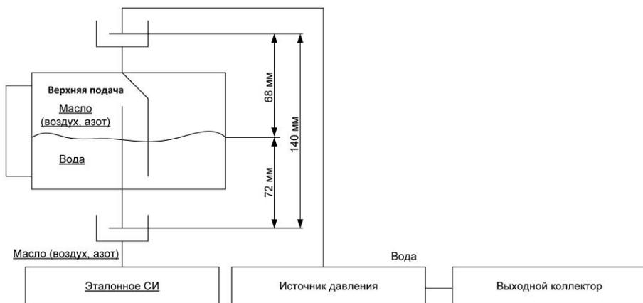
**Рисунок 3** Схема РСВ-600 с верхней подачей рабочей жидкости
