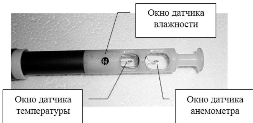
Рис.2. Головка сенсометрического щупа
