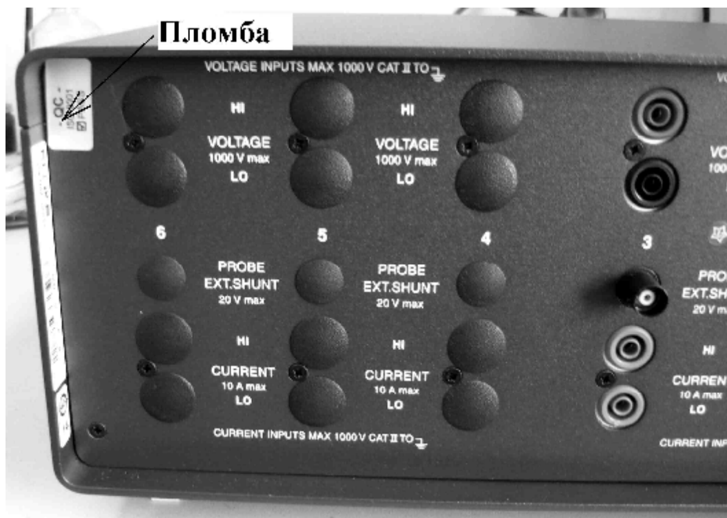
Рисунок 4. Схема пломбирования регистраторов модели Fluke Norma 5000.
