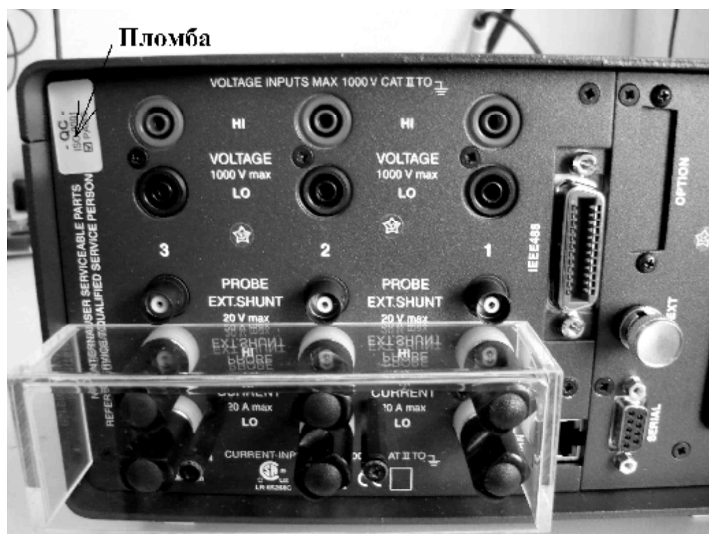
Рисунок 3. Схема пломбирования регистраторов модели Fluke Norma 4000.
