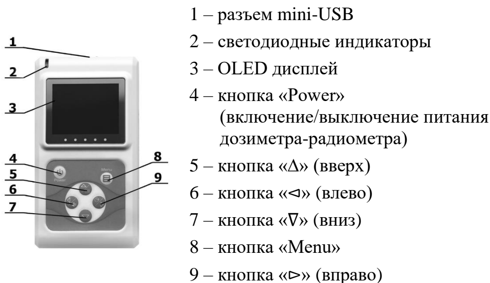
Рисунок 1 – Внешний вид лицевой стороны дозиметра-радиометра
