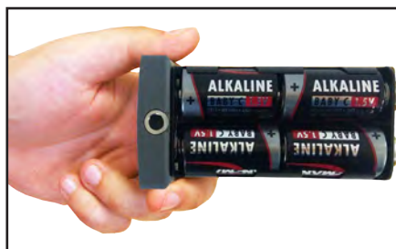
б) Вставить батареи в отсек, соблюдая полярность
