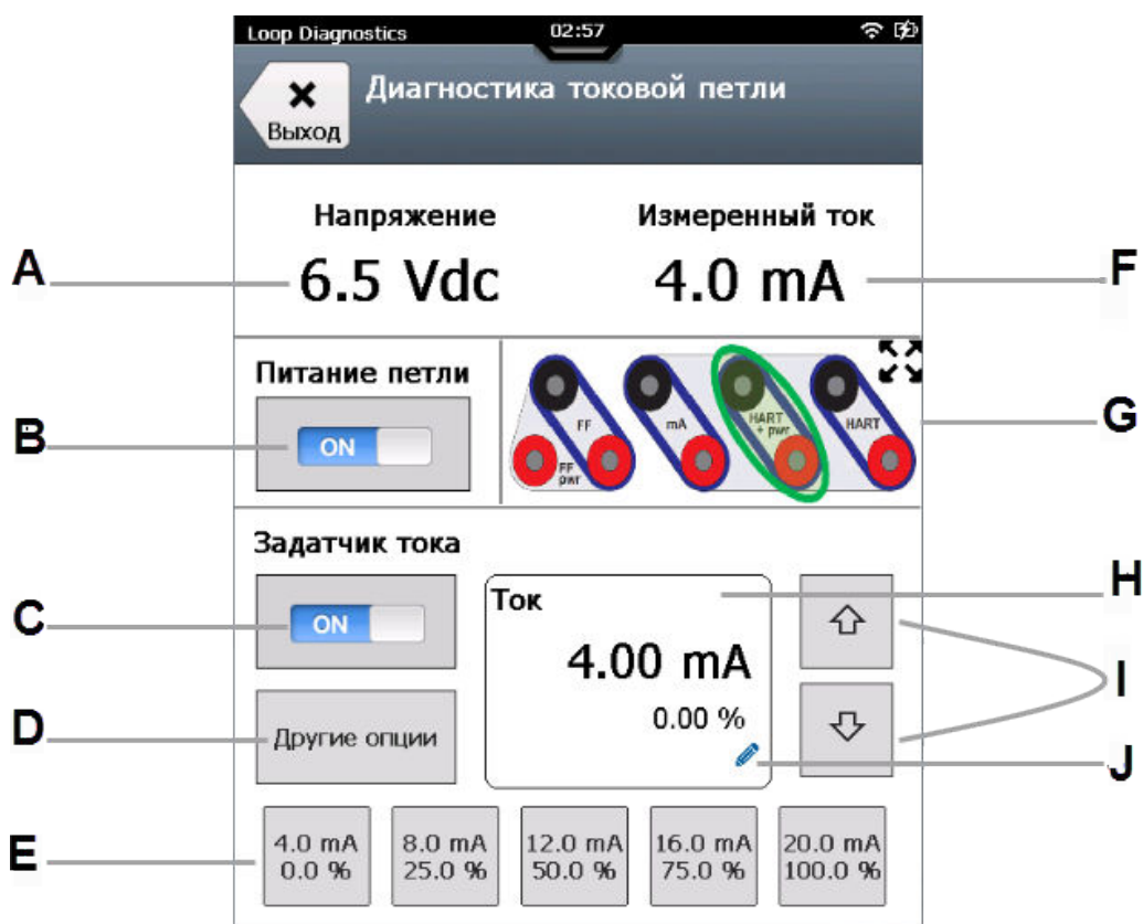
Рис. 4-2: Диагностика токовой петли при подаче питания на позиционер клапана
