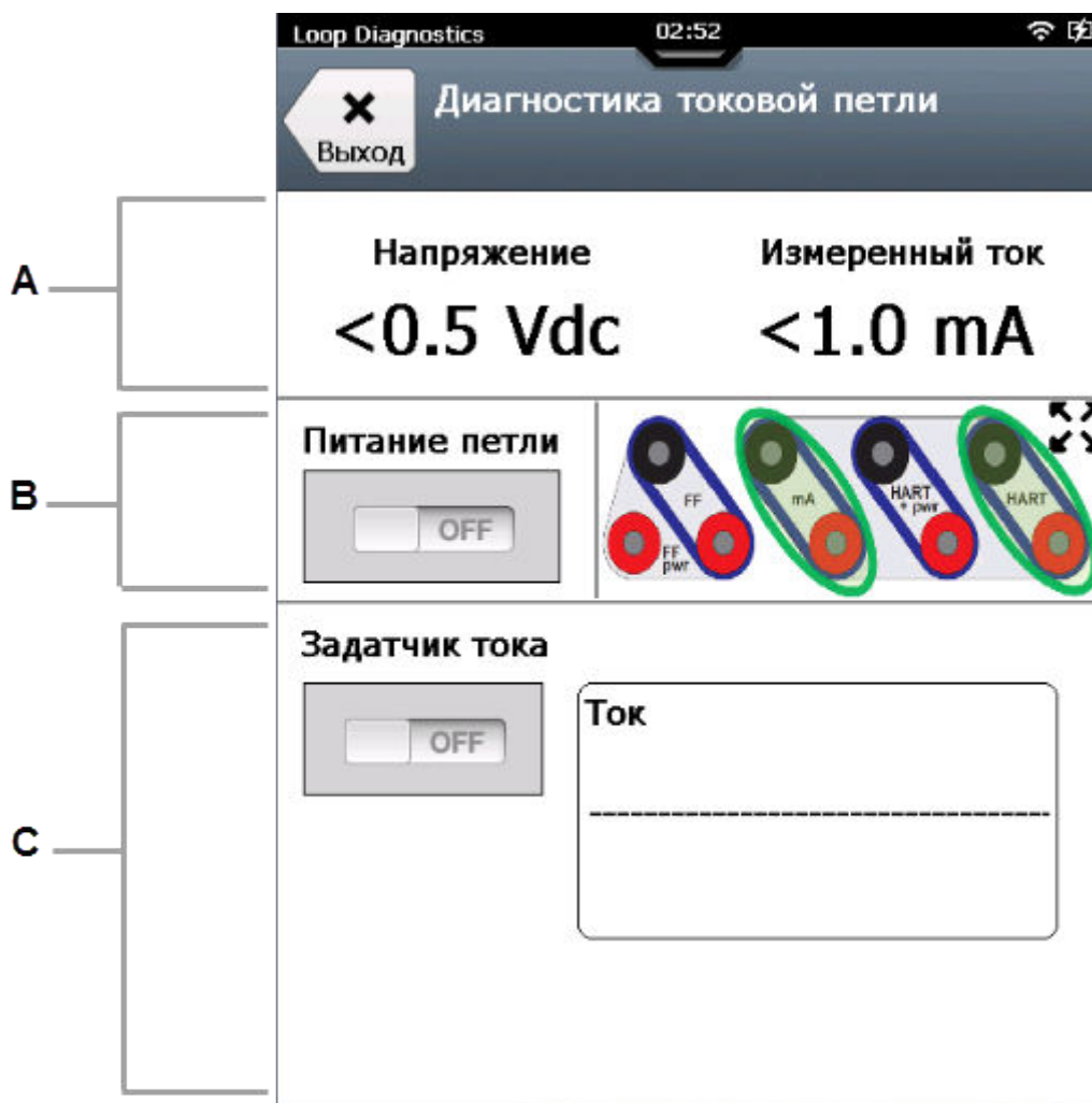
Рис. 4-1: Диагностика токовой петли при запуске
