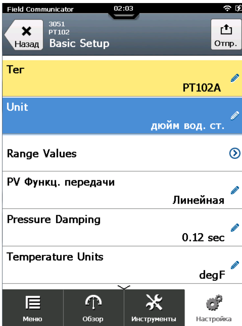
Рис. 3-32: Измененный параметр подсвечен желтым цветом
