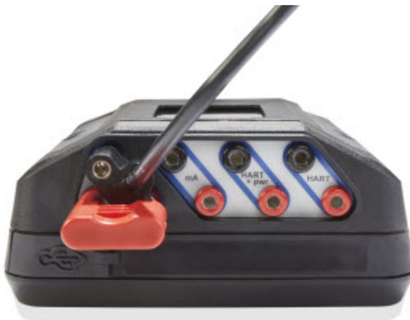
Рис. 2-12: Вилка для питания устройств с выходным сигналом FOUNDATION Fieldbus крепится к коммуникатору Trex
