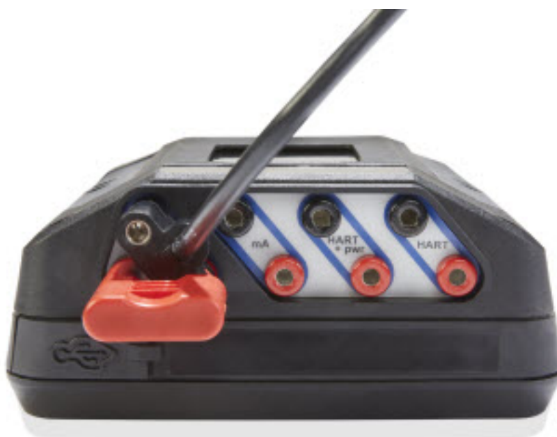
Рис. 3-36: Вилка для питания устройств с выходным сигналом FOUNDATION Fieldbus крепится к коммуникатору Trex
