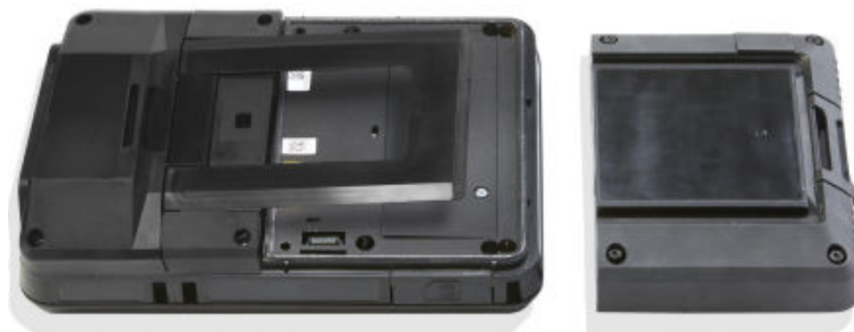
Рис. 2-10: Коммуникатор Trex без модуля питания
