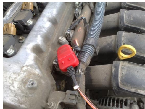
Рисунок 20 — Примеры подключения Crocodile к проводам ТС
