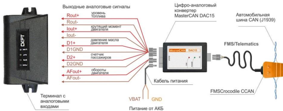
Рисунок 24 — Пример подключения FMSCrocodile CCAN для конвертации данных CAN-шины в аналоговые входы телематического терминала
