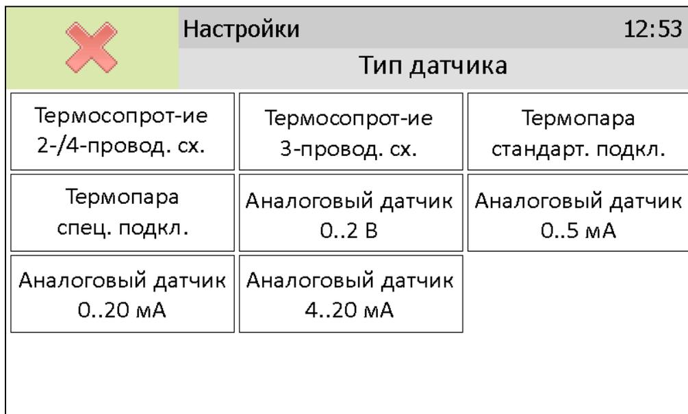
Рисунок 6.22 Выбор типа датчика.
