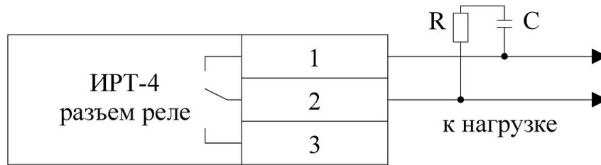
Рисунок 3.7 Подключение нагрузки к выходу управления
