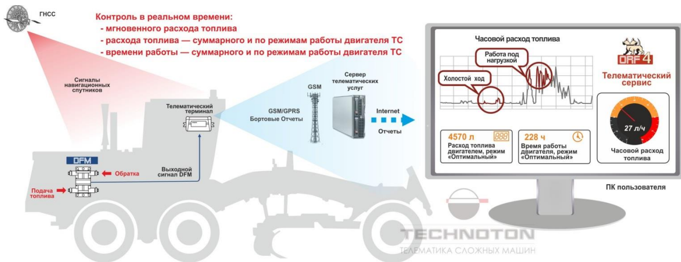
а) пример использования DFM D в составе Телематической системы на автотракторной технике
