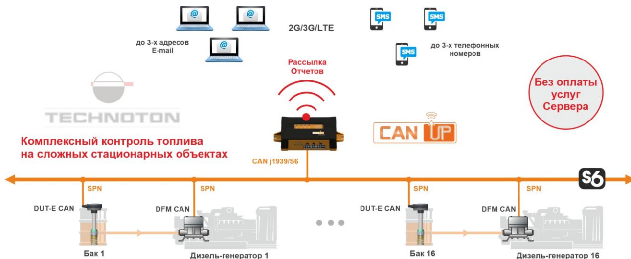
б) пример использования DFM CAN по Технологии S6 в составе Телематической системы на сложном стационарном объекте
