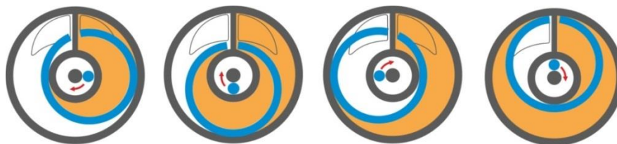
Рисунок 17 — Схема работы измерительной камеры DFM
