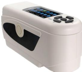
Прецизионный колориметр со сферической геометрией измерения 8°/d. Апертура 10 мм делает прибор популярным для самых разнообразных применений: текстиль, пластмасса, бумага, лакокрасочные и строительные материалы. Эргономичная, небольшая конструкция и доступ в одно касание к интерфейсу измерений делают колориметр очень удобным для контроля цвета.
