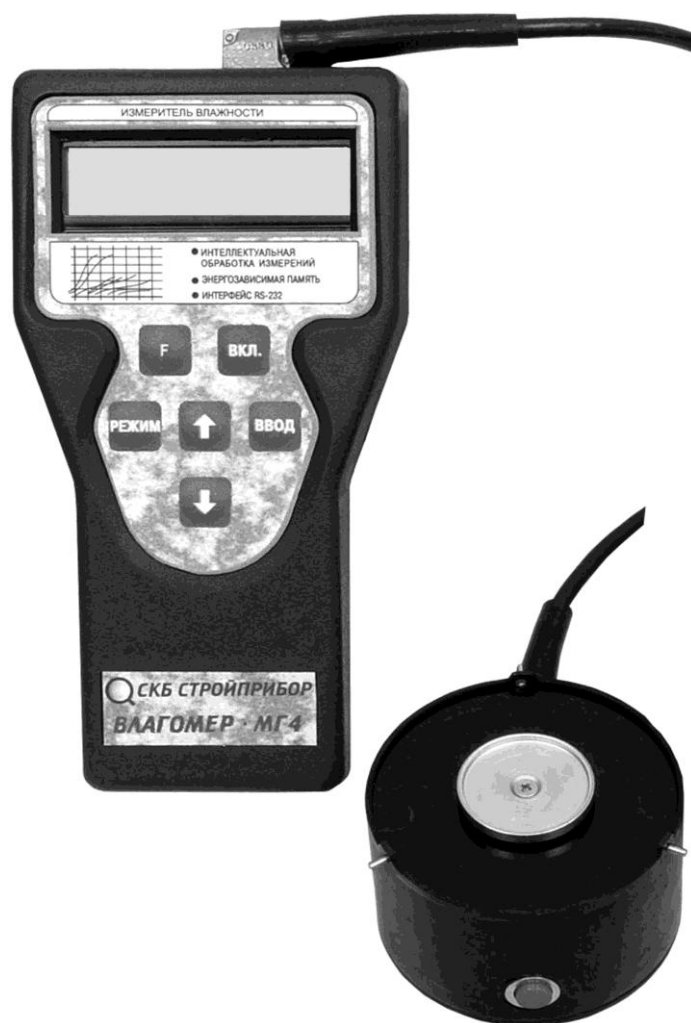
Рисунок 1 - Общий вид Влагомера-МГ4-Д
