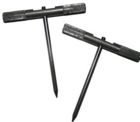
Рисунок 10 - Приспособления для крепления сейсмоприемников на грунт
